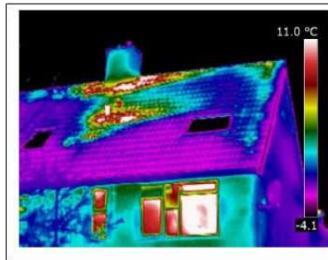
Voorbeelden van ontbrekend isolatiemateriaal bij scheidingswanden, pijpjes en schoorstenen in de dakconstructie
