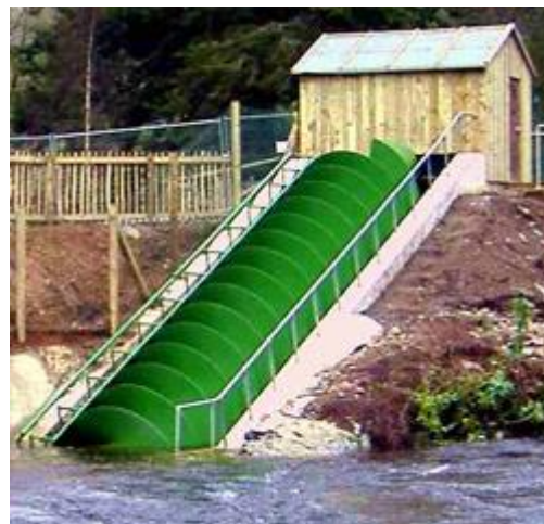
Figuur 3-3: Voorbeeld Archimedes generator
